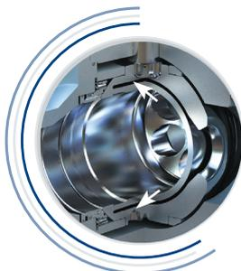
В конструкции пробки крана скребкового предусмотрена байпасная полость. Она обеспечивает прохождение потока рабочей среды через кран в положении «закрыто» (в момент ввода или вывода очистного поршня). Сечение байпаса составляет  $\approx 25\%$  от сечения трубопровода. При этом давление среды в трубопроводе не изменяется.
